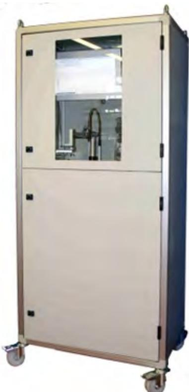
EASYCHEM TOX EW, su numunelerinde canlı lüminesans bakteri kültürlerini kullanarak toksisite analizi yapan tam otomatik bir analizördür.
