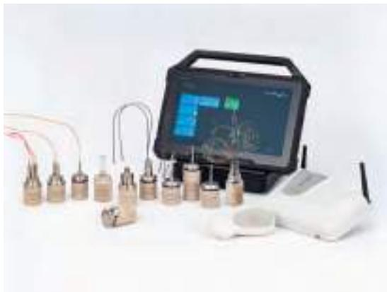
Kaye ValProbe® RT (Gerçek Zamanlı), en yoğun şekilde kontrol edilen endüstrilerin ölçüm ve raporlama gereksinimleri etrafında tasarlanmış, kablosuz, gerçek zamanlı bir süreç doğrulama ve izleme sistemidir.
