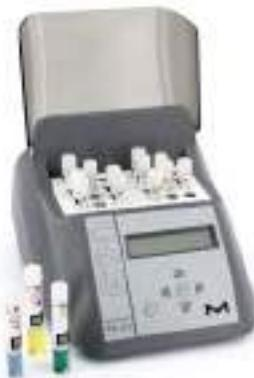
Özellikle su, atık su analizlerinde su içerisinde çözünmüş iyonların haricinde bağlı ve kompleks bileşenlerin de tespit edilmesi gerekebilir. Bunun için numune yüksek ısıda parçalanır. Merck Crack setler bu çalışmalar için gerekli olan küvet ve reaktifleri komple bir set halinde sağlar. Farklı crack setler vardır.
